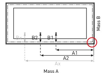
Ausgangspunkt Vermessung Griffbohrung
