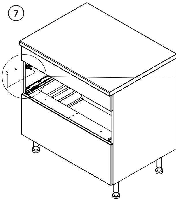
Montieren Sie die Schrauben mit PZ1 bit
