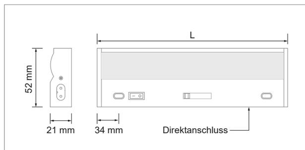
**!** Direktanschluss durch Elektroinstallateur
